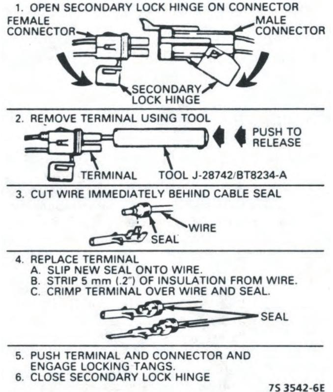
**FIGURE 3 WEATHER PACK TERMINAL REPAIR**
